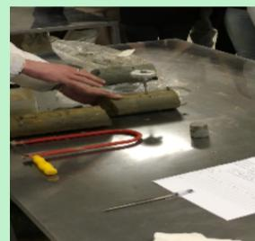
**La prova con pocket penetrometrico** consiste nell'inserire nel campione di terreno una sonda metallica e nel misurare la resistenza (kg/cm<sup>2</sup>) che offre il terreno alla penetrazione
