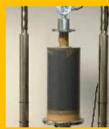
**Aerometria o densimetria:** è un'analisi granulometrica che può essere svolta per via indiretta secondo la legge di Stocks o per via diretta attraverso l'uso di setacci. La prova per via indiretta viene fatta solitamente per terreni a grana fine nei quali non è possibile l'uso dei setacci e utilizza un metodo che sfrutta la sedimentazione del campione sul fondo per gravità.
