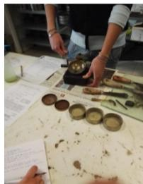
**Prova di compressione a espansione laterale libera (ELL):** serve per calcolare la coesione Cu dei terreni argillosi (parametro utilizzato per calcolare la portanza dei terreni coesivi). La prova consiste nel comprimere con una pressa un provino cilindrico di terreno fino a portarlo a misurare il carico di rottura in Kg/cm<sup>2</sup>. La coesione Cu corrisponde alla metà del carico di rottura stimato.
