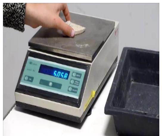
**Indice di forma:** La prova si effettua su materiale inerte proveniente da cava o da riciclo. Con un calibro vengono misurati lunghezza (L) e spessore (E) dei singoli inerti costituente il materiale da testare per stabilire se risultano rotondeggianti o appiattiti.
